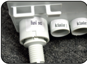
FALSCH Der Kabelstecker ist nicht bündig
